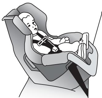
Детское автомобильное сиденье, установленное в обратном положении
