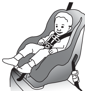
Детское автомобильное сиденье, установленное в нормальном положении
