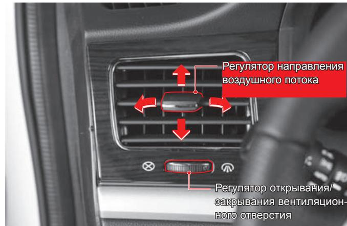
Вы можете отрегулировать направление воздушного потока, перемещая регулятор отверстия для выпуска воздуха.
