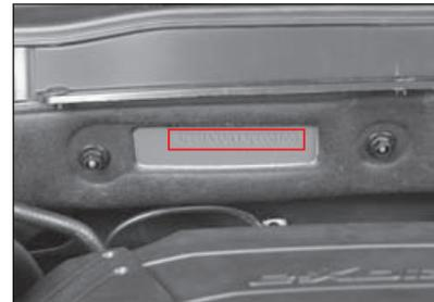
Номер VIN выбит на перегородке моторного отсека со стороны переднего пассажира.
