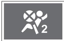
Данная контрольная лампа загорается при отключении подушки безопасности со стороны переднего пассажира, когда соответствующий переключатель установлен в положение «OFF».
