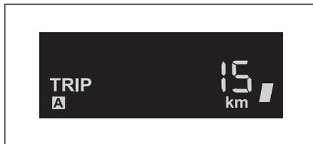
В данном режиме на дисплее отображается расстояние, пройденное в ходе отдельной поездки в км (или милях).
