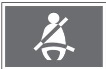
Данная контрольная лампа загорается, если ключ в замке зажигания находится в положении «ON», а ремень безопасности водительского сиденья не пристегнут, при этом в течение 6 секунд будет звучать предупреждающий звуковой сигнал. Лампа и предупреждающий сигнал отключаются до истечения вышеуказанного времени, если ремень безопасности водительского сиденья будет пристегнут.
