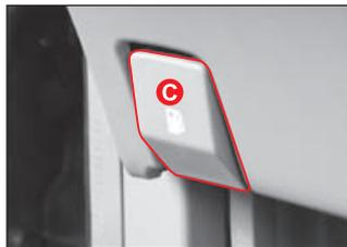
1. Откройте крышку заливной горловины топливного бака, потянув за рычаг (C), расположенный в нижней части панели управления, слева от рулевой колонки.
