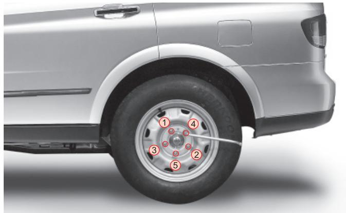
7. Устранение люфта позволяет избежать перекоса диска колеса на ступице в момент, когда колесо войдет в соприкосновение с поверхностью земли.
