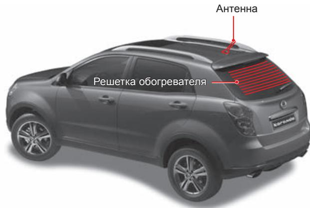
На стекло двери багажного отделения нанесена «решетка» нагревательного элемента системы обогрева. Будьте осторожны, чтобы не повредить нагревательный элемент при очистке внутренней поверхности стекла задней двери.
