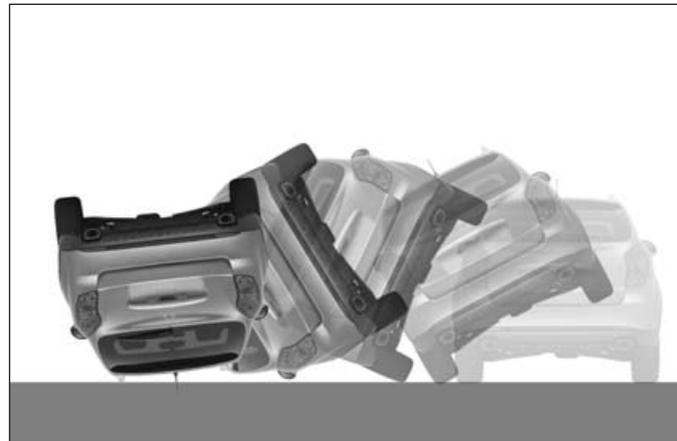
Подушки безопасности могут не сработать при аварии с опрокидыванием, поскольку раскрытие подушек безопасности не обеспечит надлежащей защиты водителя и пассажиров.
