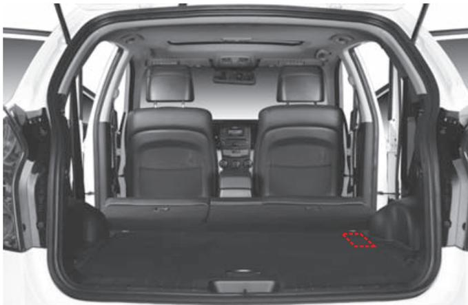
Инструменты, предназначенные для использования в экстремальных ситуациях, в том числе домкрат, принадлежности домкрата и другие, хранятся в специальном отсеке багажного отделения.
