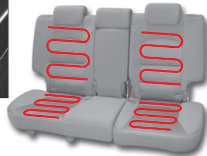
Для включения обогрева сиденья нажмите на одну из сторон клавиши соответствующего переключателя: «HI» (высокая температура), «LO» (низкая температура). При активации системы на переключателе загорается светодиод. Если установить переключатель в центральное положение, система обогрева сидений отключается.
