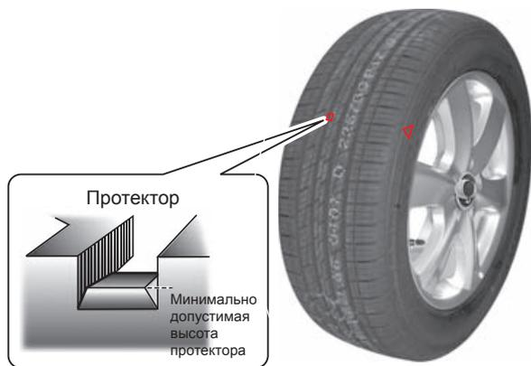
Шины автомобиля оснащены встроенными индикаторами износа, расположенными в канавках рисунка протектора. Шины следует менять, когда индикаторы износа начинают выступать над поверхностью протектора в двух или более расположенных рядом канавках.
