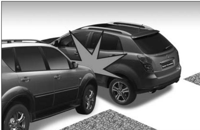
Передние подушки безопасности могут не раскрыться при боковом столкновении, потому что пассажиры двигаются в сторону столкновения, и, следовательно, раскрытие передних подушек безопасности не обеспечит должной защиты.
