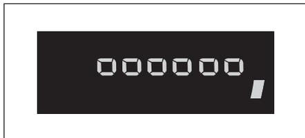
В данном режиме на дисплее отображаются 6 уровней интенсивности подсветки комбинации приборов.
