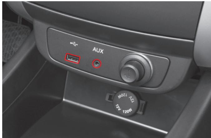
На данном автомобиле предусмотрены USB-порт и разъем AUX. Их можно использовать для прослушивания музыки, записанной на флэш-накопителе или воспроизводимой на внешнем аудиоустройстве, при этом звук будет транслироваться через динамики аудиосистемы.
