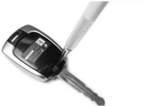
2. Выверните два винта крепления задней крышки.
