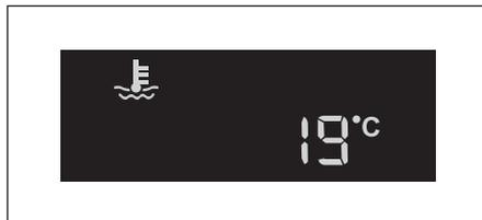
В данном режиме на дисплее отображается значение температуры наружного воздуха (только для системы климат-контроля)
