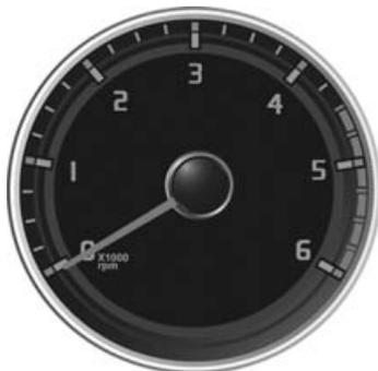
Тахометр показывает частоту вращения коленчатого вала двигателя в оборотах в минуту. Для определения числа оборотов отображаемое значение необходимо умножить на 1000.
