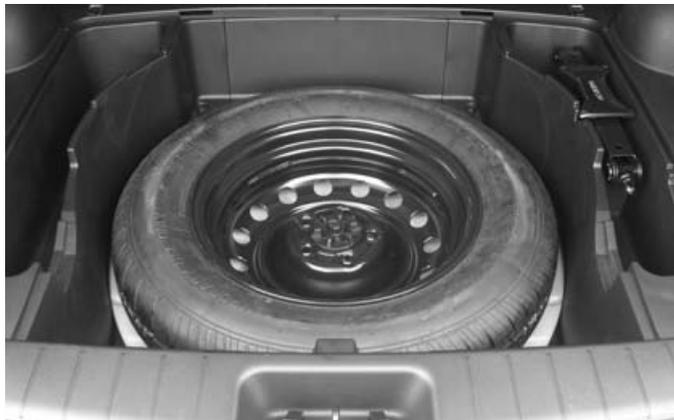
Откройте крышку нижнего отсека багажного отделения и снимите запасное (аварийное) колесо.
