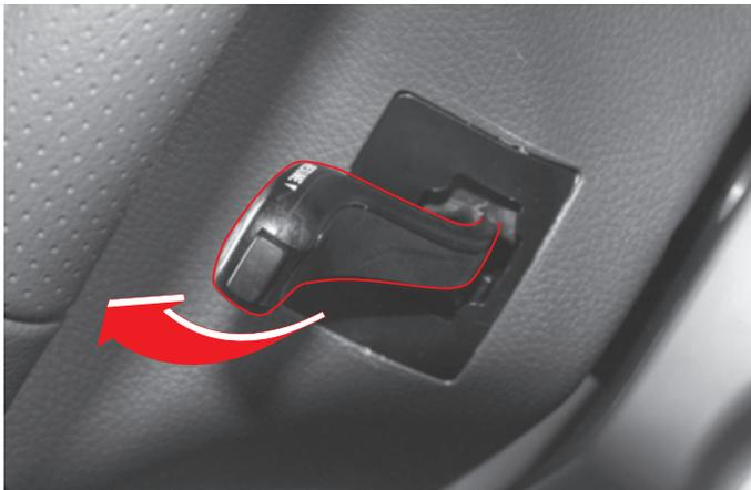
После отключения круиз-контроля можно вновь активировать систему с восстановлением последнего значения крейсерской скорости, отжав рычаг переключателя круиз-контроля по направлению к рулевому колесу, если при этом скорость движения автомобиля выше 38 км/ч. Но при выключении зажигания внесенная в память настройка скорости будет стерта, и восстановить ее невозможно.
