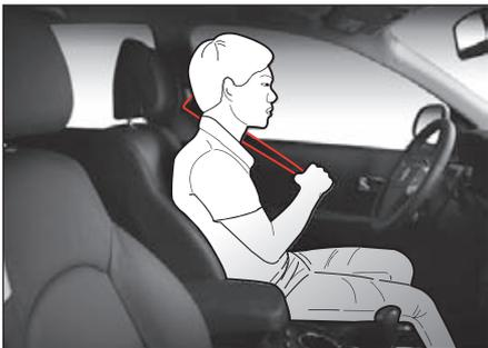
1. Вытяните металлическую застёжку из натяжителя. Если ремень блокируется, когда вы тянете его, отпустите его назад в натяжитель и вытяните его на нужную длину.
