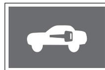
Данная контрольная лампа начинает мигать при определении неисправности в системе иммобилайзера.
