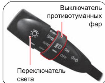
Данный переключатель предназначен для включения/выключения наружных световых приборов (фар, задних фонарей, габаритных огней, подсветки номерного знака, сигналов поворота, противотуман-
