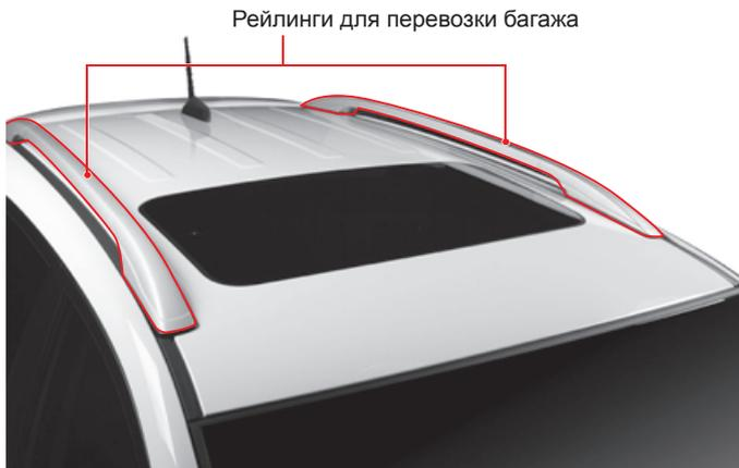
Если автомобиль оборудован рейлингами для перевозки багажа и установки верхнего багажника, можно осуществлять перевозку багажа на крыше автомобиля.
