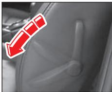
Поверните рычаг вперед, чтобы переместить поясничную опору вперед. Чтобы убрать ее, поверните рычаг назад.
