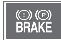
Если контрольная лампа ABS и контрольная лампа тормозной системы горят одновременно, то система EBD (система распределения тормозных усилий) неисправна. При этом антиблокировочная система (ABS) также не функционирует.
