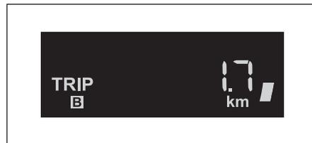
В данном режиме на дисплее отображается расстояние, пройденное в ходе отдельной поездки в км (или милях).
