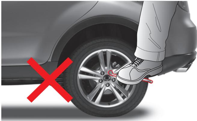
При прикладывании чрезмерного усилия для затяжки возможно повреждение гаек. Не перетягивайте гайки крепления колеса, нажимая на ключ ногой или используя удлинители ключа.
