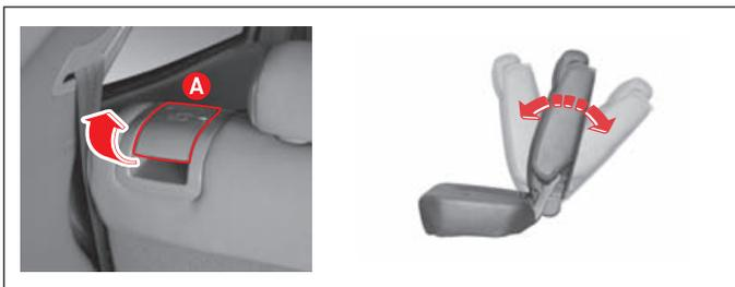
Чтобы изменить наклон спинки сиденья, уберите вест тела со спинки и поднимите рычаг (A) вверх. Затем откиньтесь на спинку кресла, установите наиболее удобный угол наклона и отпустите рычаг. После регулировки убедитесь, что рычаг вернулся в исходное положение и спинка зафиксирована..
