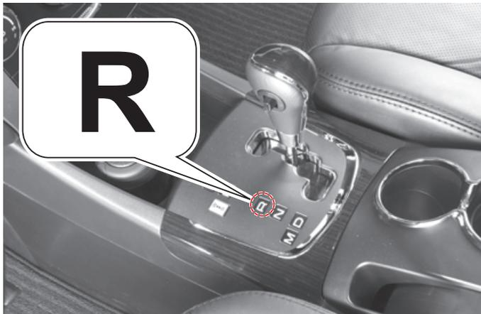
Данное положение рычага используется для включения передачи заднего хода.
