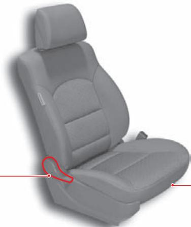
**Регулировка наклона спинки**
