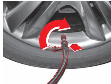
7. Отверните колпачок ниппеля колеса и подсоедините шланг компрессора так, чтобы он доходил до нижнего края резьбы ниппеля.
