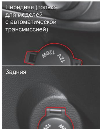
В салоне автомобиля установлена дополнительная розетка для подключения электроприборов. Питание к розетке подается, когда ключ в замке зажигания находится в положении «АСС» или «ON».
