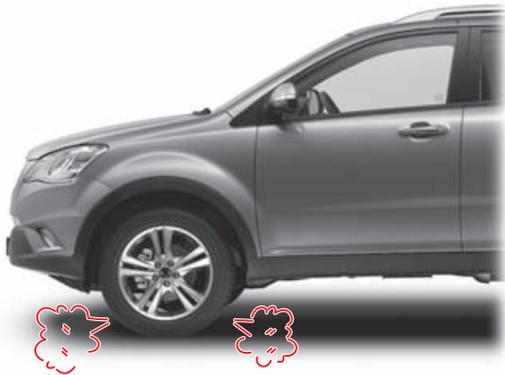
В случае прокола одной из шин во время движения крепко удерживайте рулевое колесо и уберите ногу с педали акселератора. Постепенно снизьте скорость и припаркуйте автомобиль в безопасном месте. Замените колесо со спущенной шиной запасным (аварийным) колесом. Описание процедуры приведено в соответствующем разделе.
