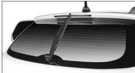
1. Извлеките ключ из замка зажигания и отведите рычаг стеклоочистителя от поверхности заднего стекла.
