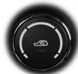
1. Чтобы отрегулировать температуру, поверните этот регулятор.
