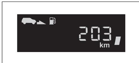
В данном режиме на дисплее отображаются расчетный показатель расстояния, которое может пройти автомобиль при оставшемся объеме топлива в топливном баке.
