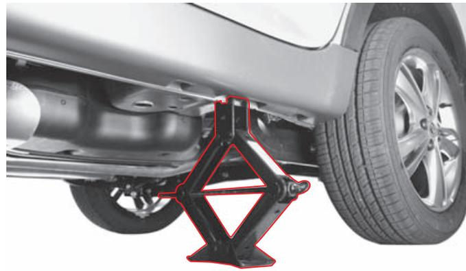
2. Установите домкрат так, чтобы его верхняя часть вошла в контакт с кузовом в специально предназначенном для этого месте.
