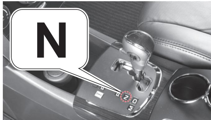
При этом положении рычага крутящий момент двигателя не передается на трансмиссию.
