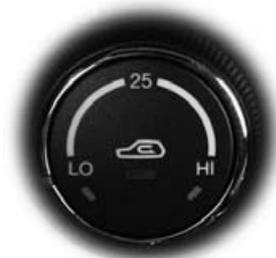
1. Чтобы отрегулировать температуру, поверните этот регулятор.
