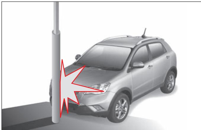
Подушки безопасности могут не раскрыться, если автомобиль сталкивается с такими объектами, как столбы коммунальных служб или деревья, когда точка удара сконцентрирована в одном месте и датчикам не сообщается полная сила воздействия.
