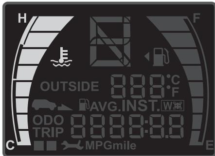
Данный индикатор показывает температуру охлаждающей жидкости двигателя. Двигатель может перегреваться.
