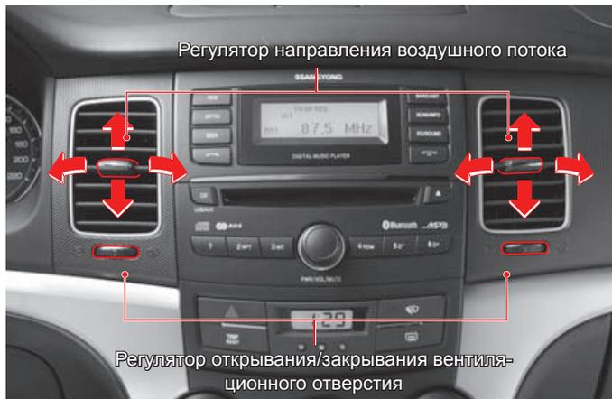
Отрегулировать направление воздушного потока можно, перемещая ручку в горизонтальном или вертикальном направлении.
