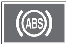
Данная контрольная лампа загорается при переводе ключа в замке зажигания в положение «ON» и должна погаснуть, если система исправна.
