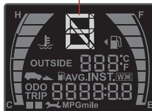
Данный индикатор отображает включенную в текущий момент передачу. В обычном режиме: P, R, N, D
