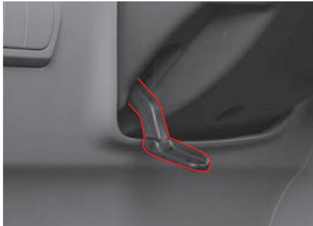
На автомобилях, оборудованных системами EPS и HPS, можно отрегулировать угол наклона рулевой колонки, а на моделях с EPS можно также отрегулировать и расстояние до рулевого колеса (телескопическая система). Для выполнения регулировки необходимо отжать рычаг фиксатора рулевой колонки вниз, а после завершения регулировки вернуть рычаг в первоначальное положение и зафиксировать колонку.
