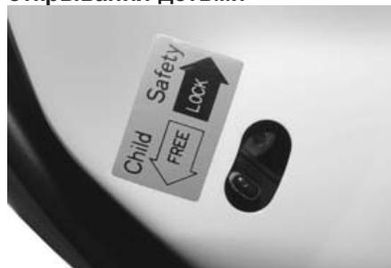
Блокировка замка предотвращает случайное открывание дверей, особенно когда в автомобиле находятся дети. При установке рычага блокиратора в положение «**LOCK**», задние двери можно открыть только снаружи.
