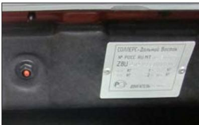
Идентификационная табличка установлена в подкапотном пространстве
