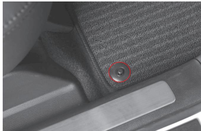
Напольный коврик должен быть закреплен при помощи фиксаторов, расположенных на полу.
