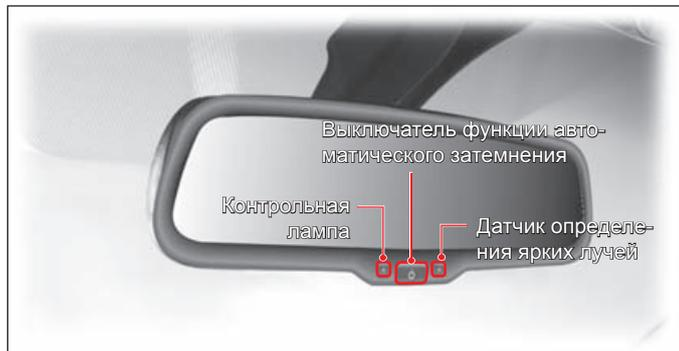
Отражающая способность внутреннего зеркала заднего вида может быть автоматически изменена в зависимости от яркости света фар приближающихся сзади транспортных средств. Для этого необходимо нажать кнопку выключателя функции автоматического затемнения. При нажатии кнопки на зеркале загорается соответствующая контрольная лампа. При повторном нажатии кнопки функция отключается и контрольная лампа гаснет.
