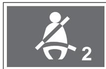
Данная контрольная лампа загорается, если ключ в замке зажигания находится в положении «ON», а ремень безопасности водительского сиденья не пристегнут, при этом в течение 6 секунд будет звучать предупреждающий звуковой сигнал. Лампа и предупреждающий сигнал отключаются до истечения вышеуказанного времени, если ремень безопасности переднего пассажирского сиденья будет пристегнут.
