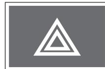
Данная лампа мигает при включении аварийной сигнализации.
