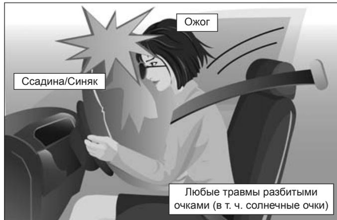
Если модуль управления подушками безопасности обнаруживает воздействие при аварии, он передает сигнал для раскрытия подушек безопасности. Этот сигнал вызывает взрыв пороха в модулях подушек безопасности, и подушки очень быстро раскрываются для защиты водителя и пассажира. Когда срабатывают подушки безопасности, появляется громкий звук, яркий свет и дым. Вы можете получить косвенные травмы в результате раскрытия подушки, в частности, ссадины, синяки, ожоги или травмы из-за разбитых очков.
