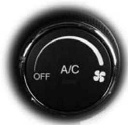
1. Чтобы отрегулировать скорость вентилятора, поверните этот регулятор.
