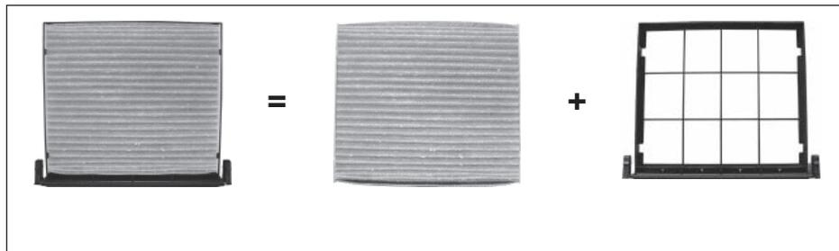
6. Снимите фильтрующий элемент с рамки и замените его новым.
