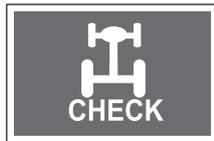
Данная контрольная лампа загорается при переводе ключа в замке зажигания в положении «ON» и должна погаснуть, если система исправна.
