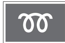
Данная контрольная лампа загорается при переводе ключа в замке зажигания в положение «ON» и продолжает оставаться включенной в течение короткого промежутка времени, либо сразу гаснет. Когда свечи накаливания достаточно разогрелись, лампа гаснет. На автомобиле, оборудованном двигателем с прямым впрыском, данная контрольная лампа может включаться на очень короткое время или не включаться совсем.
