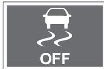
Данный индикатор загорается при нажатии выключателя «ESP OFF», отключающим систему ESP.
