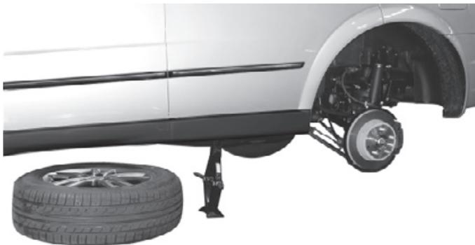
5. Снимите колесо и уложите его под кузов автомобиля. Это позволит уменьшить риск получения серьезных травм и повреждений при соскальзывании домкрата.
