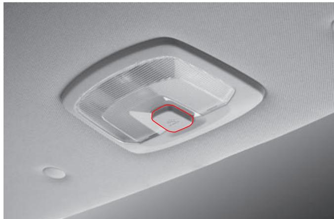
Если кнопка данного выключателя находится в нажатом положении светильник багажного отделения включается/выключается при открывании/закрывании двери багажного отделения (режим совместного функционирования).
