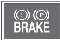
Данная контрольная лампа загорается, когда задействован рычаг стояночного тормоза и/или уровень тормозной жидкости в бачке ниже заданного значения.
