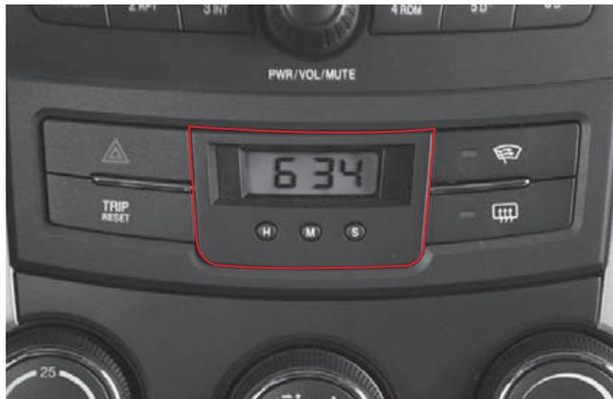
**H (ЧАСЫ):** Кнопка для установки часов
