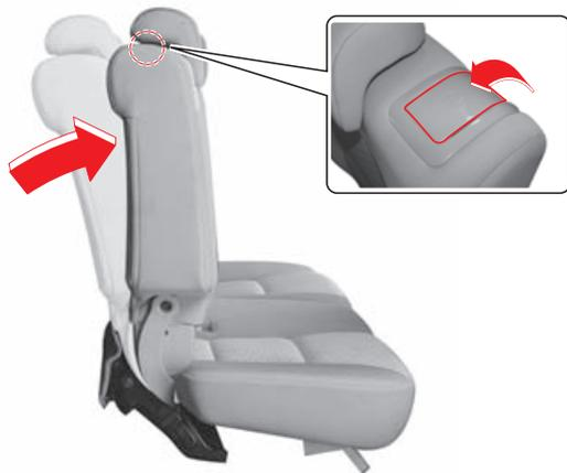
1. Потяните рычаг регулировки спинки заднего сиденья вверх и установите ее в вертикальное положение.
