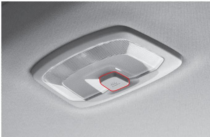
При нажатии кнопки данного выключателя загорается центральный светильник салона. При повторном нажатии кнопки светильник будет отключен. Однако, если выключатель основного освещения салона будет находиться в нажатом положении, данный светильник включается/выключается при открывании/закрывании дверей (режим совместного функционирования).
